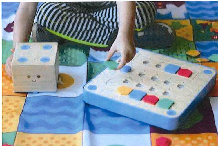
Der Cubetto ist ein Holzroboter mit Rollen. Er lässt sich mit bunten Bausteinen auf dem Bedienfeld steuern. Jede Farbe steht für eine andere Bewegung, die der Roboter ausführen soll. Foto: Hersteller
